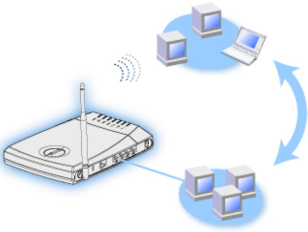
無線寬頻路由器可支援多達 252 個客戶端，而其中 16 個客戶端可以是無線客戶端。網路位址轉譯 (NAT) 功能可以讓 64 個客戶端同時與網際網路進行通訊。內建的乙太網路無線存取點能以 11 兆位元/秒 (Mbps) 的速率運作，而 LAN 有線連接埠的傳輸率卻只有 10/100 Mbps。無線寬頻路由器和每部電腦間的最大距離是 300 英尺。視作業環境而定，其距離可能會較短。
